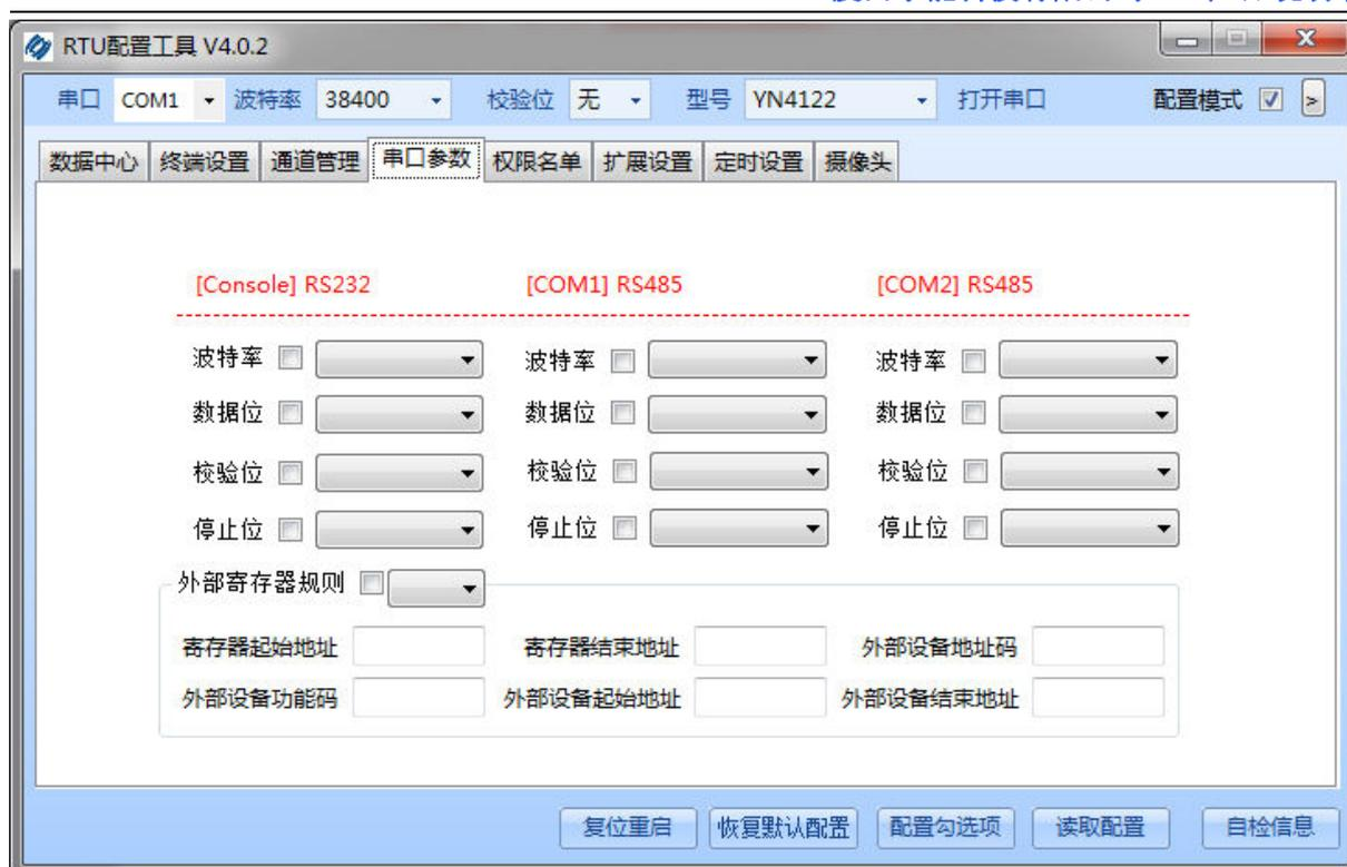
主串口为 RS232 接口同时也是配置接口，串口 1 和 2 和为 RS485 接口，串口 1 支持 MODBUS-RTU 主站功能及透明传输功能，串口 2 支持串口摄像头并通过 FTP 协议上报。
