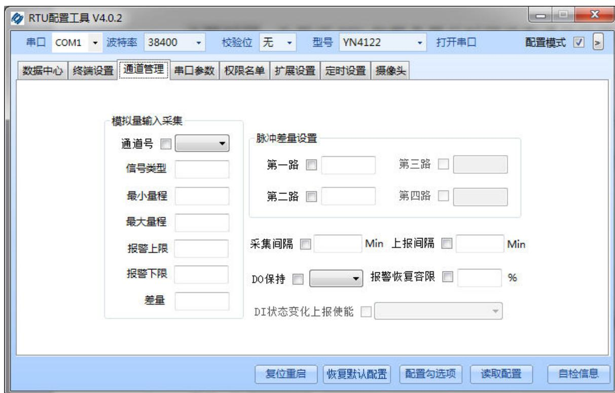
**信号类型**: 模拟通道的类型，分为 4~20mA 和 0~5V 两种类型。
