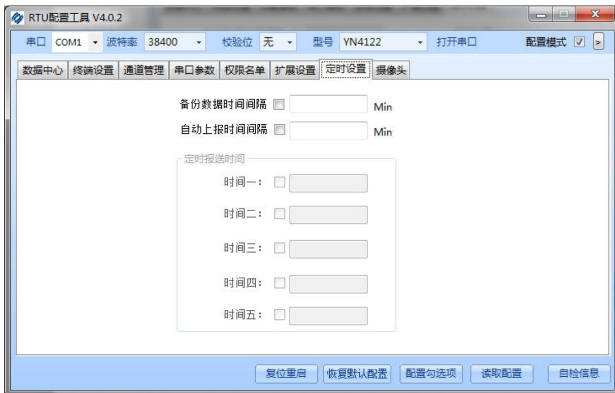
**备份数据时间间隔**：RTU 定时采集并存储采集值的时间间隔，单位为分
